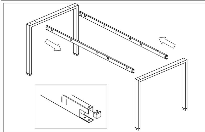
1 - Collegare i longheroni centrali ai traversi delle gambe. I longheroni hanno un orientamento preciso, seguite la descrizione grafica della figura a lato. E' importante inserire i tappi alle teste dei longheroni prima di fissare le viti. Seguite l'orientamento dei tappi descritto nel riquadro.
