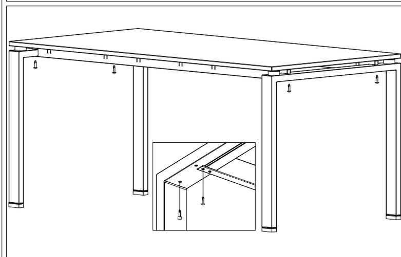
3 - Posizionare il piano sui longheroni, le viti (B) verranno inserite all'interno dei fori e si avviteranno nelle boccole corrispondenti al piano stesso. Fissare i distanziali utilizzando le viti (C) attraverso i fori dei traversi per poi riprendersi nelle boccole del piano. Seguite la figura nel riquadro a lato.
