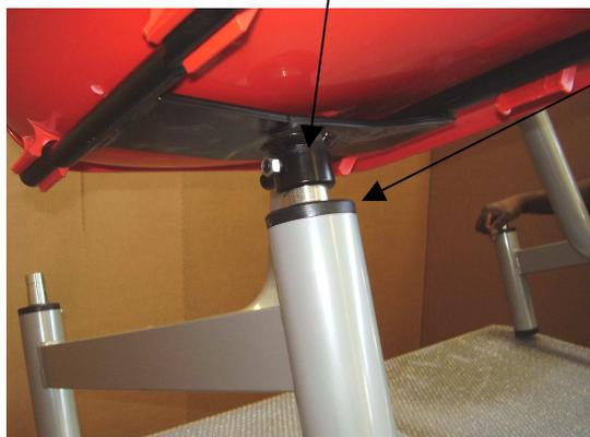
Avvitare a fondo il **grano** con chiave a brugola da 4 mm e serrare il **controdado**, con chiave fissa da 13 mm, del blocchetto conico **H** al fine di evitare il disassamento accidentale della seduta rispetto al piano tavolo.
