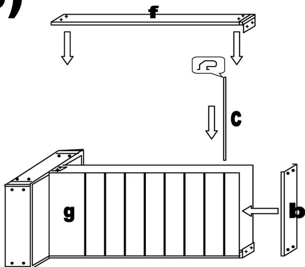
Inserire i pannelli(g) e infilare nelle fresate i copriguida(c) nel verso indicato dalla figura. Applicare ai 2 montanti(f) gli angolari ed infine unire il montante(b) rimanente all'insieme.
