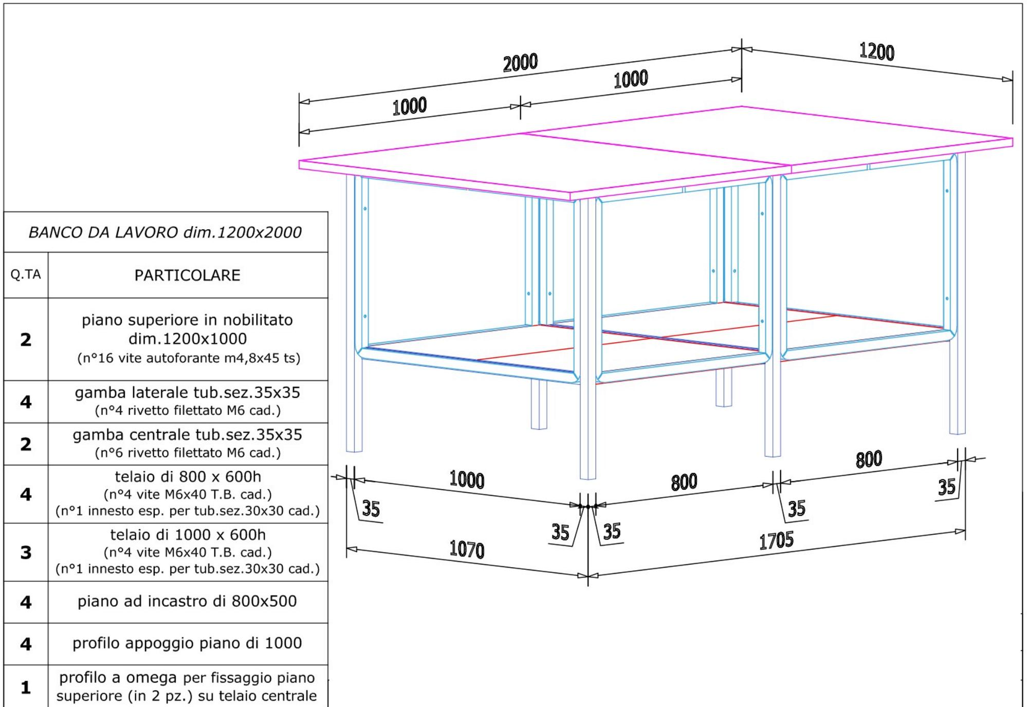
profilo a omega per fissaggio piano superiore
